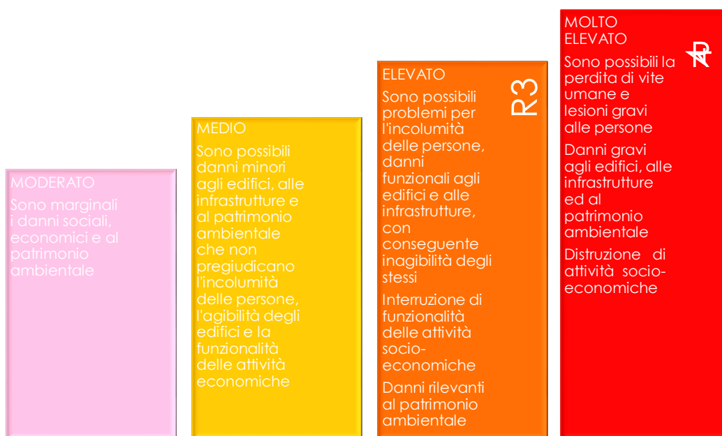
Figura 11. Rischio idrogeologico. Classi di rischio.
